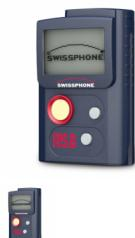
RES.Q-G Funkterminal, integrierter POCSAG-Empfänger, PLL-Technik, 128 Adressen (32 RIC), Express-Alarm; zeigt programmierte und freie Texte (105 Zeichen) - GSM-/GPRS-Modul (Quadband) für Rückmeldung, - unterschiedliche Netzteile zur Auswahl - Optionen (Mehrkanal, Tasche, GPS, IDEA) zur Auswahl
